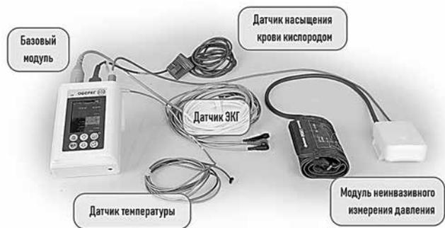
**Рис. 1.** Базовый модуль ПТС с датчиками
